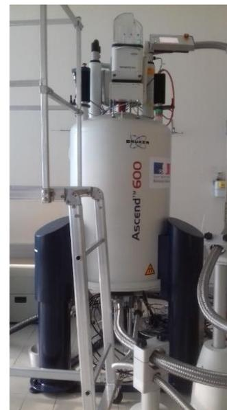
Spectromètre BRUKER AVANCE III 600MHz
