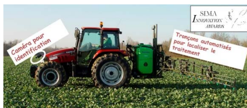
Le dispositif ILS® (Intelligent localized spray) développé par la société Tecnomia en collaboration avec AgroSup Dijon. Innovation récompensée par la médaille d'argent du SIMA 2011. Photo Tecnomia reproduite avec aimable autorisation
