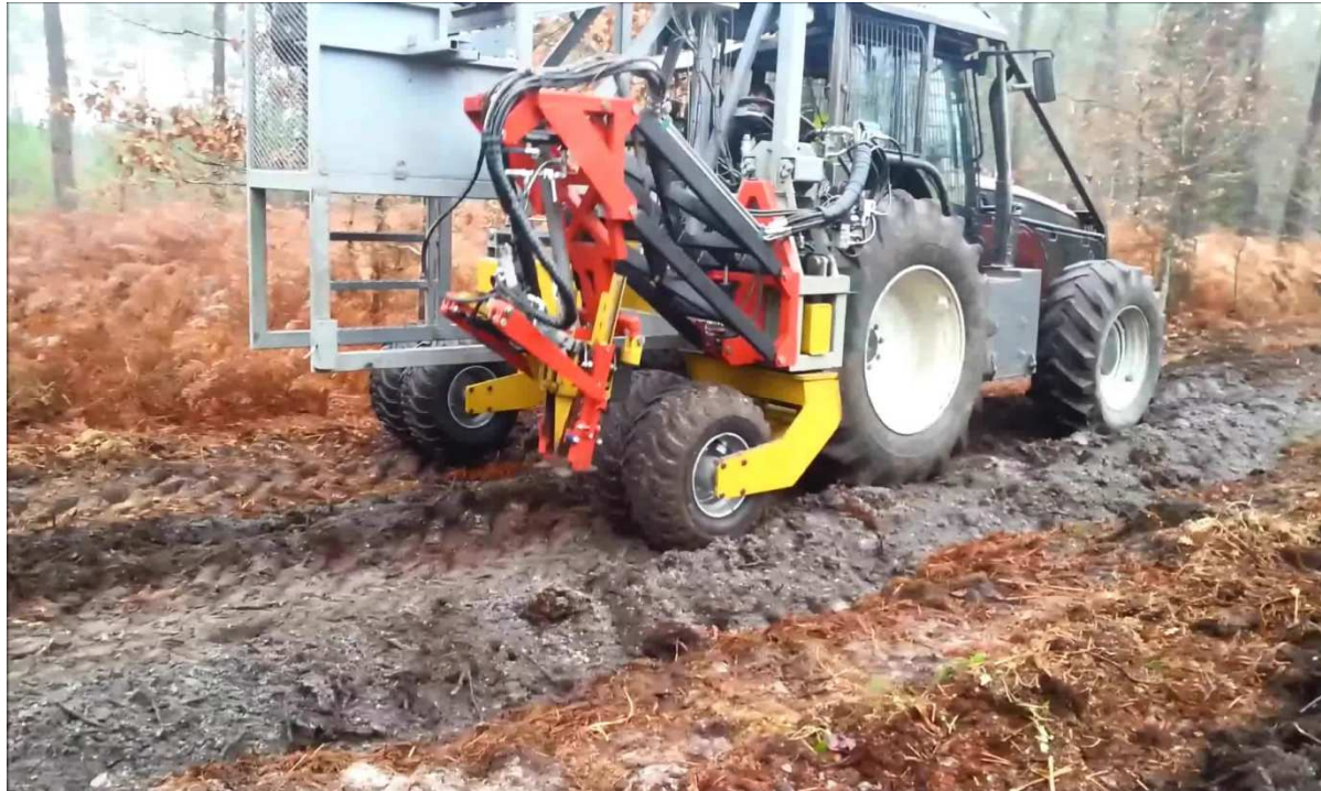
Exemple : Planteuse Grande Capacité Irstea – SATT-GC (système breveté)
