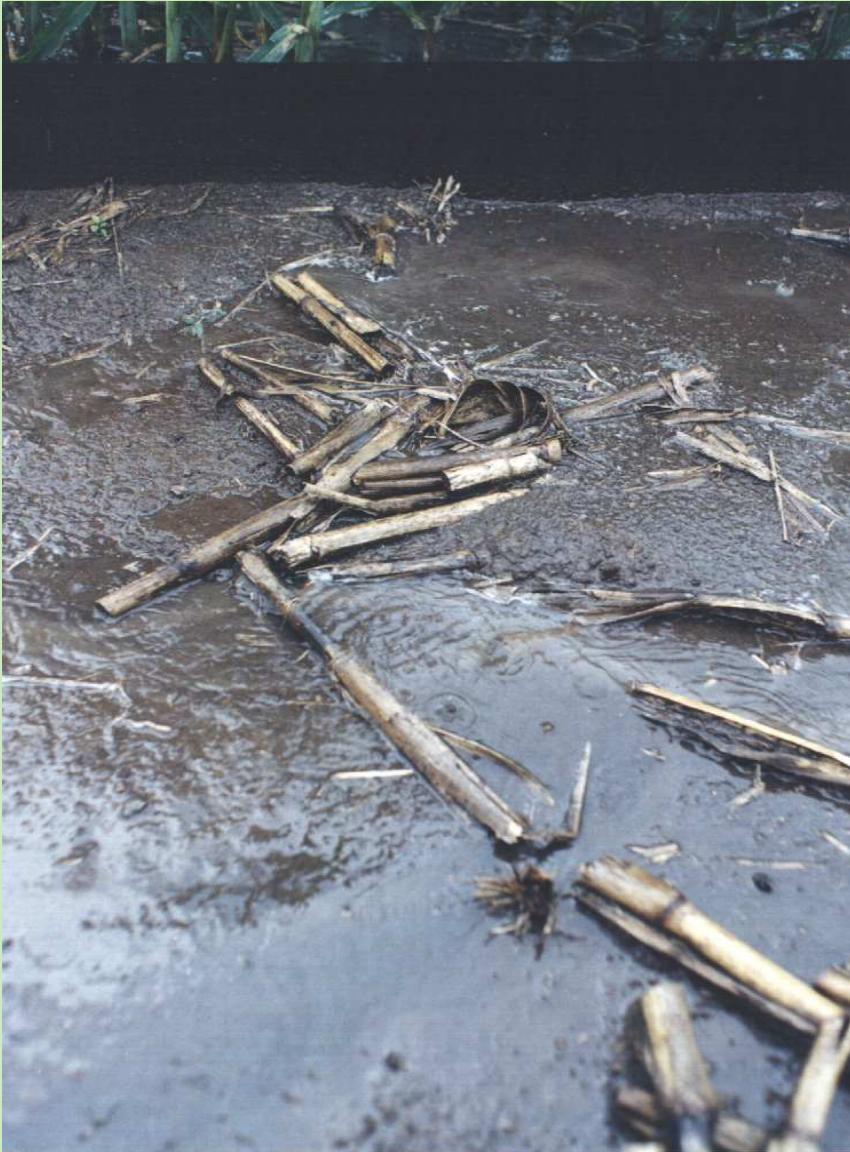
Ruissellement avec effet barrage (paillis) et sans obstacle (sol nu)
