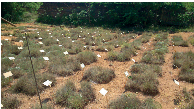
Essais de végétation pour des traitements par phytostabilisation et phytobiodégradation © F. Marot
