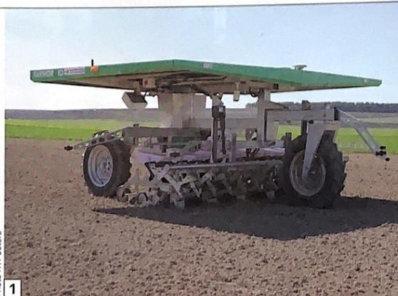
Le robot Farmdroid FD 20 est opérationnel en culture de betterave (semis et désherbage mécanique total).
