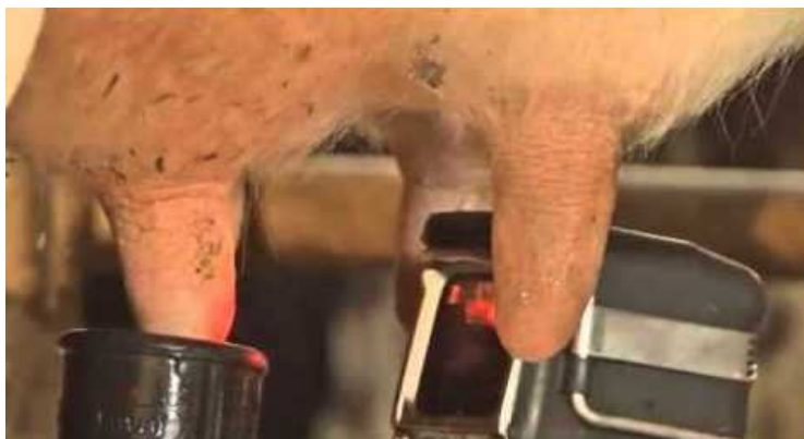
Détail du capteur optique guidant le bras © L.Vimond
