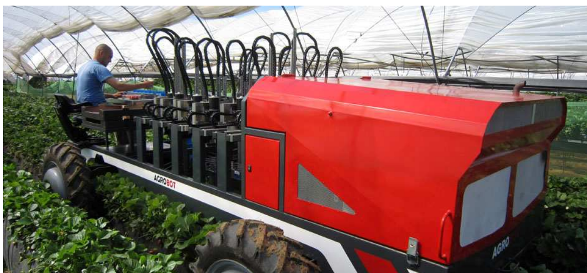
Robot de récolte de fraise Agrobot ©Agrobot
