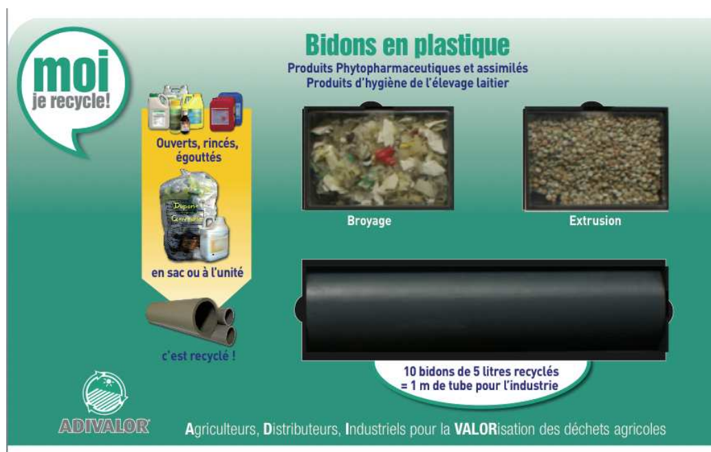
Figure 6 : Recyclage des bidons plastiques (source : A.D.I.VALOR)
