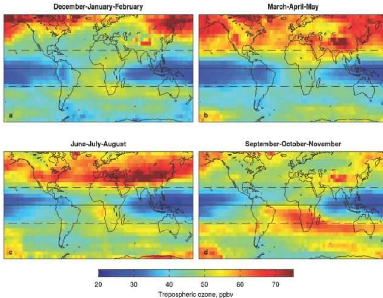
Mesures satellitaires d'ozone troposphérique obtenues d'octobre 2004 à décembre 2010 par différence entre l'ozone total mesuré par l'Ozone Monitoring Instrument (OMI) et l'ozone stratosphérique mesuré par Microwave Limb Sounder (MLS) (Source .
