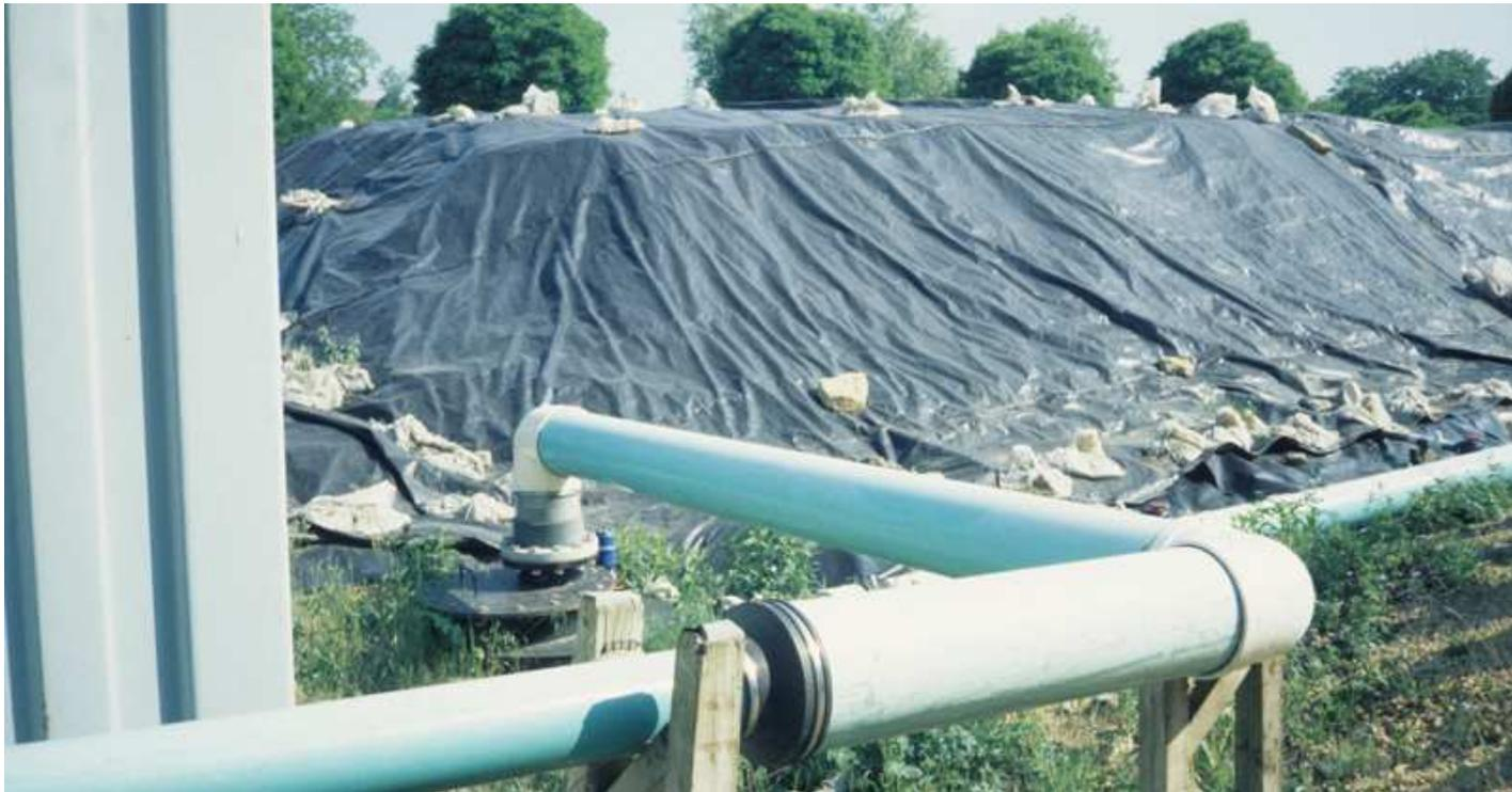
**Exemple de traitement biologique par biodégradation des Hydrocarbures Aromatiques Polycycliques (HAP)**
