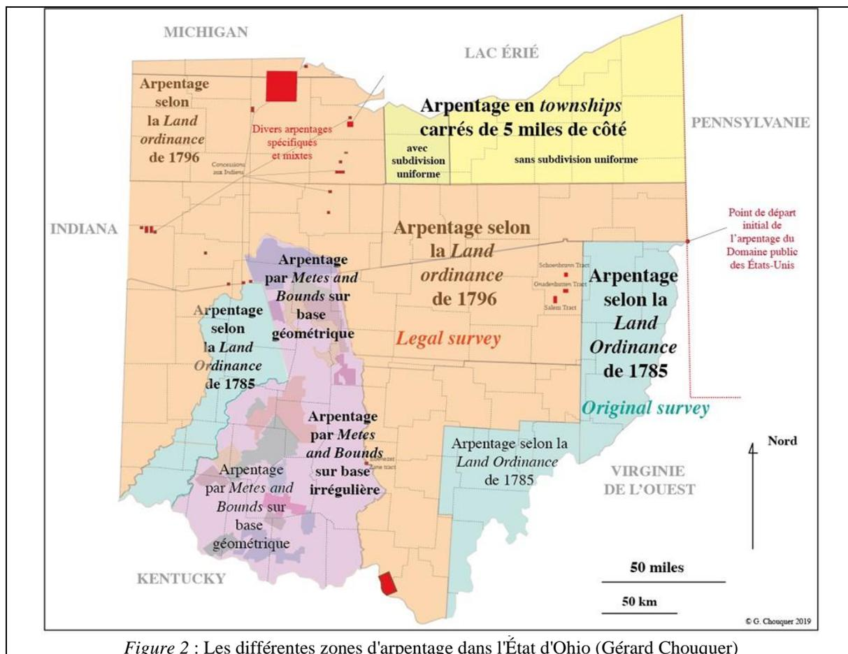
Figure 2 : Les différentes zones d'arpentage dans l'État d'Ohio (Gérard Chouquer)
