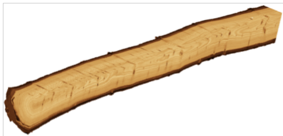
Figure 2. Reconstruction tridimensionnelle et visualisation d'un quartier de grume d'épicéa scannée. Source : projet européen FAIR CT 96 – 1915: STUD – Marc Jaeger [Cirad] et Jean-Michel Leban [Inra] (2000).
