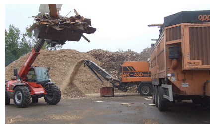
Figure 3. Le bois est réceptionné, trié puis broyé en différents calibres qui permettent d'alimenter des paneautiers ou des chaufferies (Source : http://www.bati-recyclage.fr/activites/bois/ )
