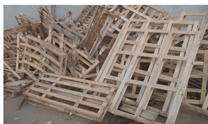
Figure 3. Le bois est réceptionné, trié puis broyé en différents calibres qui permettent d'alimenter des paneautiers ou des chaufferies (Source : http://www.bati-recyclage.fr/activites/bois/ )
