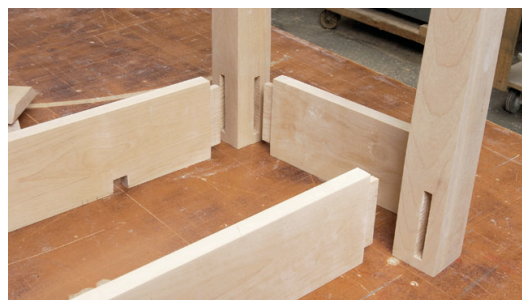
Figure 4. Assemblage par tenon et mortaise
