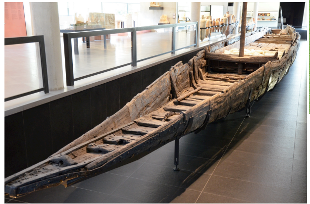
Figure 7. La barge gallo-romaine d'Arles Extraite du Rhône après 2000 ans d'immersion, cette barge de 31 m de long, était surtout faite de bois de chêne (un peu de sapin, épicéa, pin, et frêne pour le mât). L'analyse dendrochronologique a montré que les arbres ont été abattus entre 47 et 49 de notre ère, laissant supposer la construction de la barge vers 50. Source : Musée de l'Arles antique
