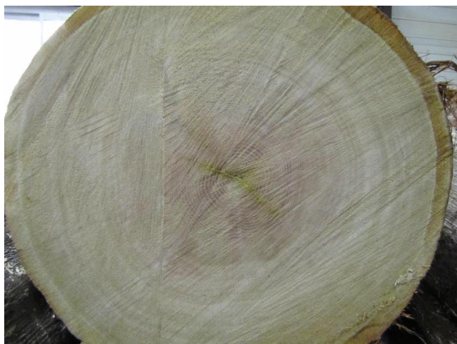
Illustration 10 : Cernes à grain fin sur coupe de chêne à merrain (© ONF/ T. Benoit, 2013)
